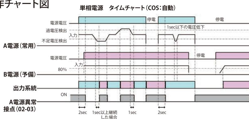
※給電系統の電源が変動すると、出力側も変動します。
